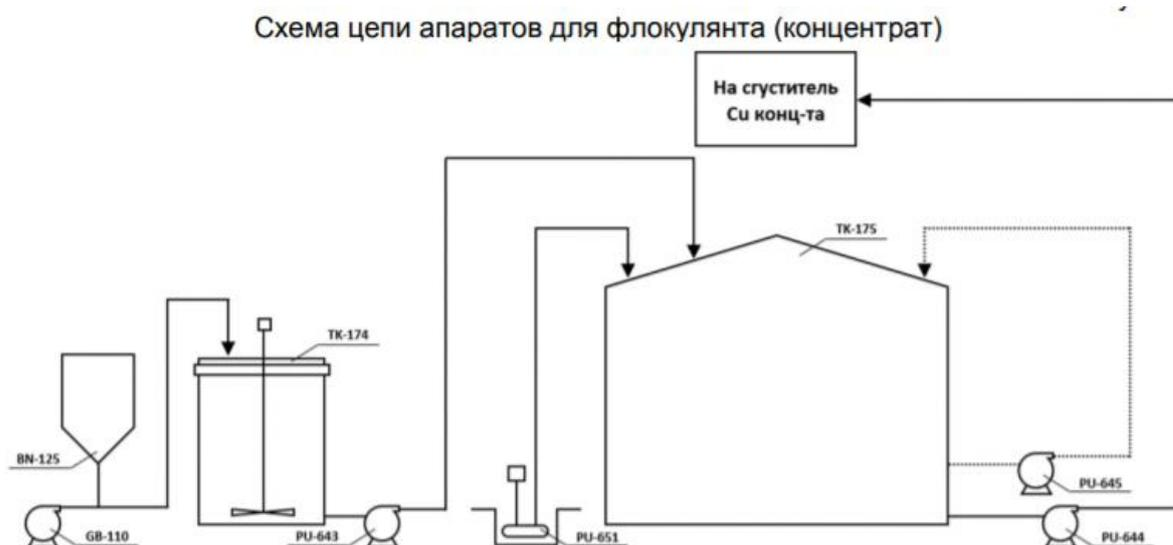
Рисунок 17 – Схема цепи аппаратов для флокулянта
