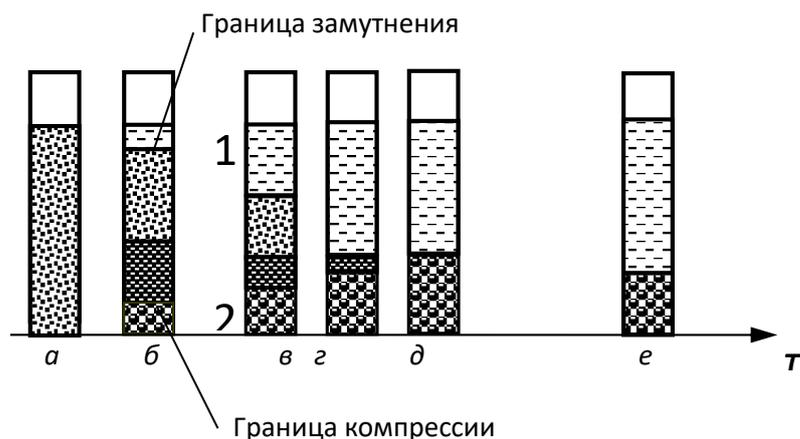
Рисунок 2 - Процессы, происходящие при осаждении
